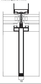
Capot en H de 34 mm. de profondeur. Capot rectangulaire: 14, 19 et 100 mm. de profondeur.
