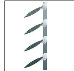
Sistema de protección solar para fachadas. Dicho sistema de lamas en aluminio de extrusión permite la regulación de la luz consiguiéndose notables ahorros en la refrigeración interior de los edificios debido a la creación de zonas de sombra que reducen la incidencia energética a la que son sometidos éstos.
